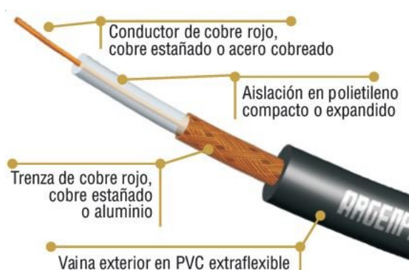
Figura 2.3: Estructura básica de un Cable Coaxial [12]
