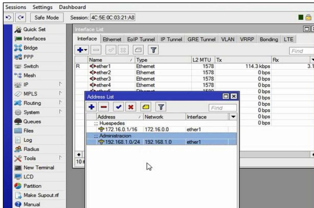
La interfaz Ethernet1 está conectada directamente al Hotel HPSM que es quien manda las direcciones a todos los AP de los demás hoteles. Cabe recalcar que el equipo Core con que estamos trabajando puede funcionar como Router y Switch, en este caso la interfaz Ethernet1 está funcionando como Router y el resto de las interfaces como Switch.
