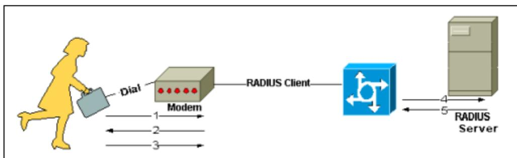
**Figura 4.3. Interacción entre un Usuario de Marcación de Entrada y el Servidor y Cliente RADIUS**
