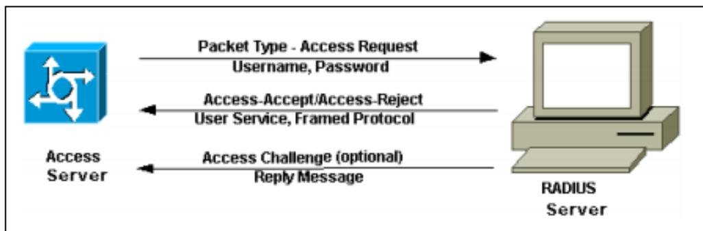
**Figura 4.4. Autenticación y Autorización Servidor RADIUS**
