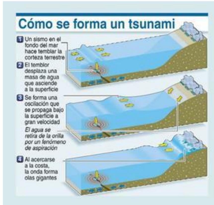
**Figura 2.2: Esquema de cómo se forma un tsunami [9]**
