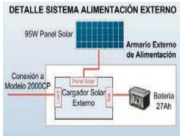
**Figura 3.10: Sistema de energía solar básico [34]**
