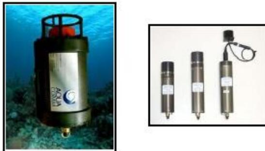
**Figura 3.9: Modem acústico y traductor [33]**
