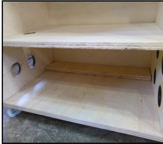
Figura 2.15: Agujeros de extracción de aire, para el sistema de ventilación y calentamiento dentro de la incubadora.
