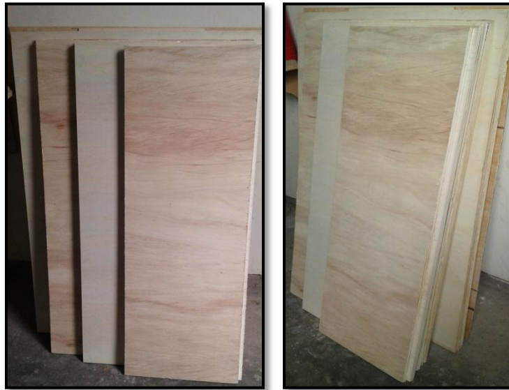
Figura 2.12: Plywood tipo B, de 15 y 3 mm de espesor, material utilizado en la construcción de la incubadora.
