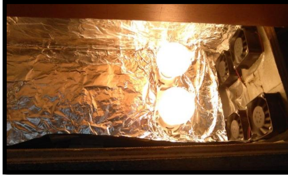
Figura 3.2: Configuración de dos bombillos de 110[W], para la generación de 37°C dentro de la incubadora.
