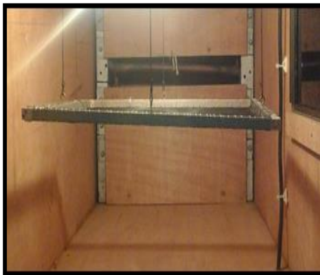
Figura 2.2: Bandeja Ubicada en el Interior de la Secadora Tipo Túnel.
