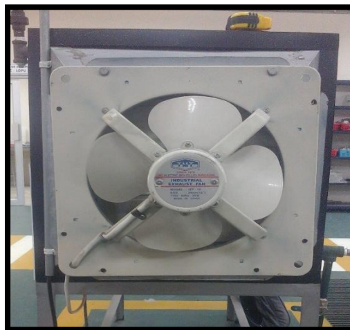
Figura 2.10: Ventilador Ubicado en la Parte Trasera del secador de Túnel
