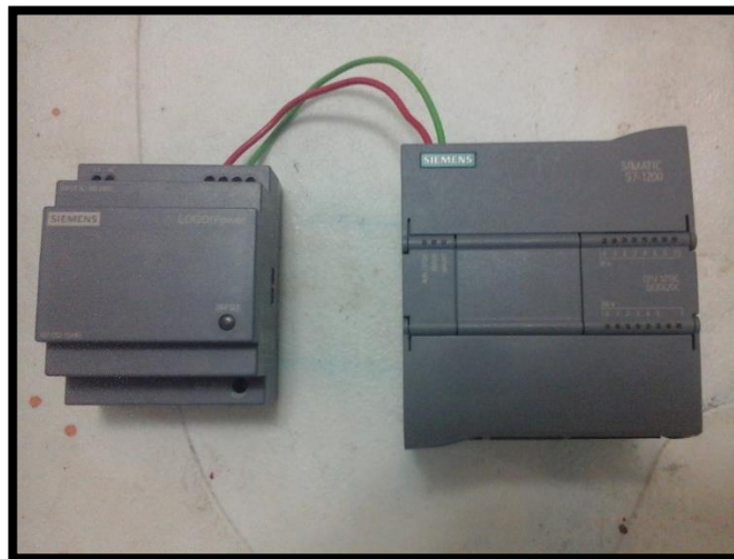
Figura 2.3: Controlador Lógico Programable SIMATIC S7-1200
