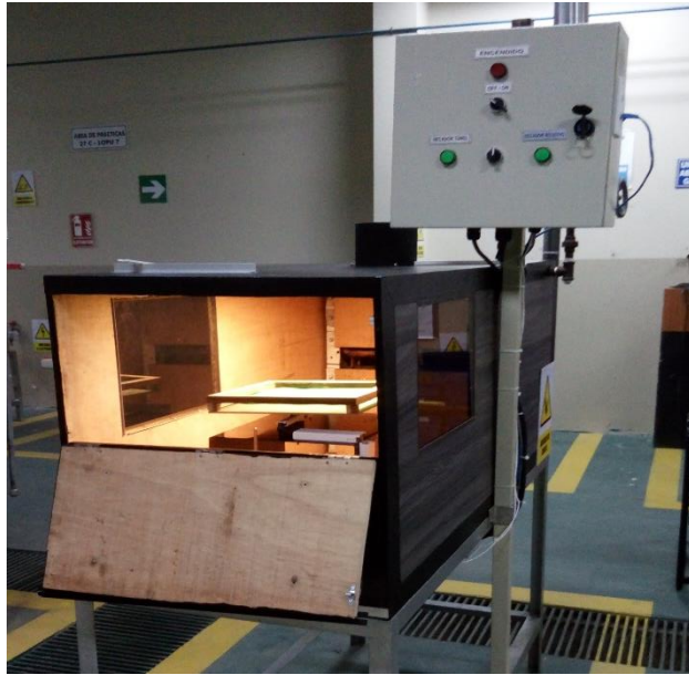
Exterior de la Secadora Tipo Túnel
