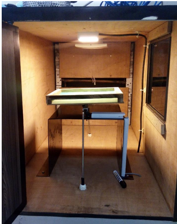
Interior de la Secadora Tipo Túnel
