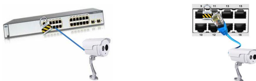
Figura 2.35 Seguridad a nivel de Puerto
