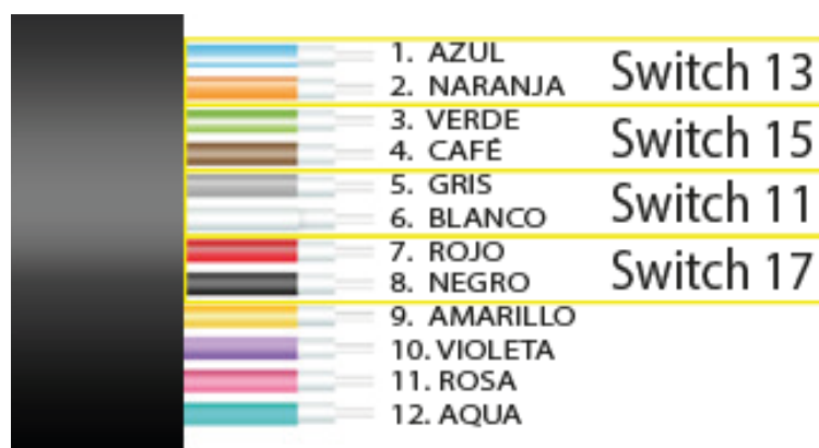
Figura 2.17 Asignación de hilos de la tercera fibra óptica multimodo que conectan el centro de cómputo con los bloques 4, 5, 6 y 7
