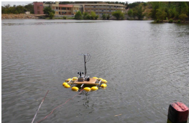
Figura 4. 3: Foto Lanzamiento de boya con eje central y peso adicional
