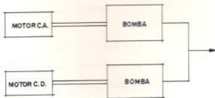
Figura 7.2. Sistema de doble bomba
