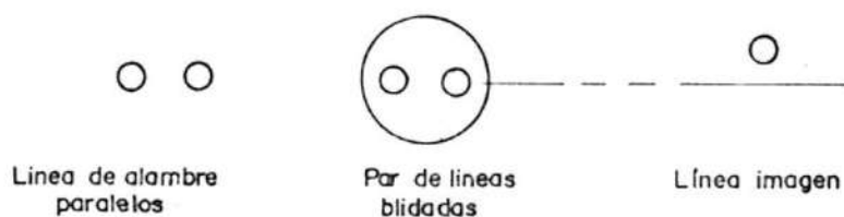
FIGURA 2.18.- DIVERSAS FORMAS DE LINEAS DE TRANSMISION.
