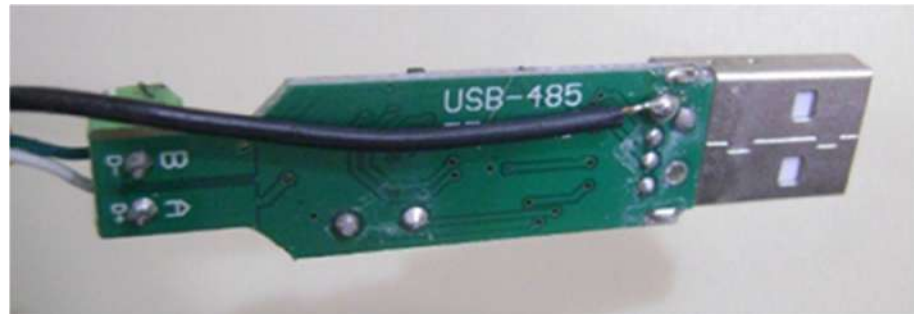
Figura 1.38: Cable conectado al pin de tierra de PL2303.
