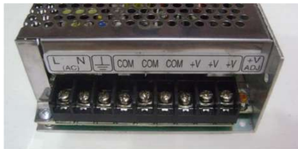
Figura 1.33: Tomas de energía.
