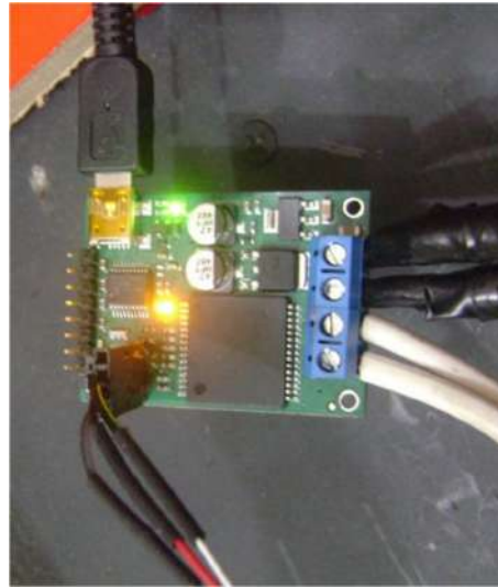
Figura 1.13: Led amarillo estado de salidas.
