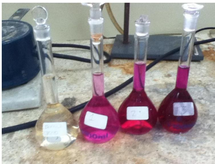
**7. Muestras coloreadas listas para medición en Espectrofotómetro UV Vis para determinación de Níquel**
