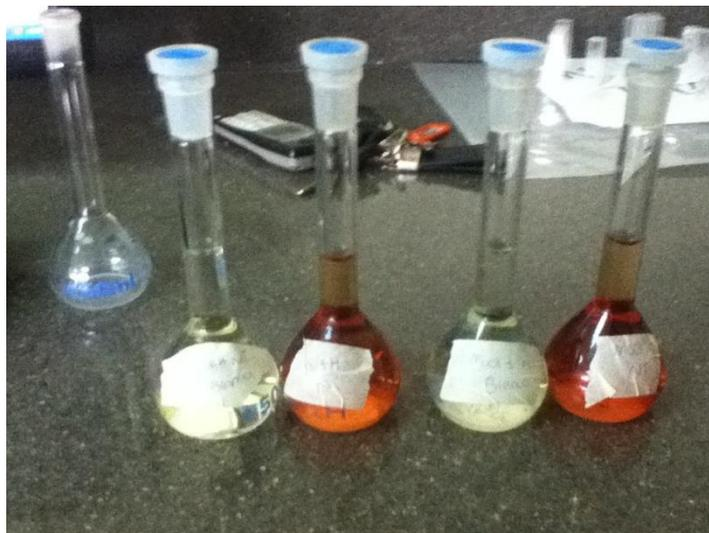
**8. Muestras coloreadas listas para medición en Espectrofotómetro UV Vis para determinación de Cromo**
