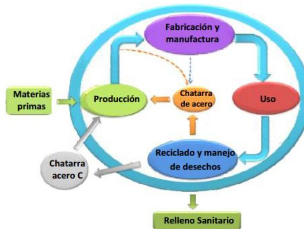
**Figura 3:** Esquema general de manufactura del Acero Inoxidable
