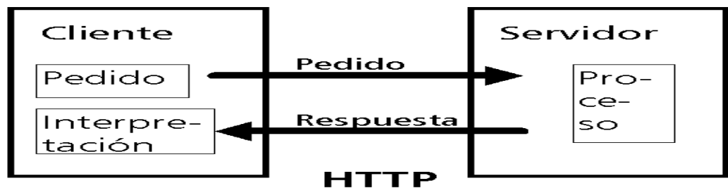
Figura 4.3. Esquema de la Arquitectura Cliente-Servidor
