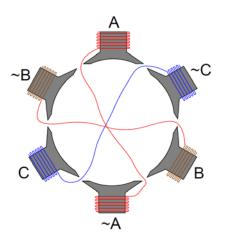
Figura 1.15: Estator con tres Fases.
