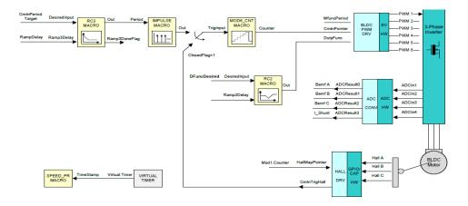
Figura 2.20: Diagrama de bloques correspondiente al nivel de compilación 3, con realimentación de sensores de efecto Hall [7].
