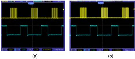
Figura 2.7: Oscilograma de las compuertas 1H y 1L para frecuencia de conmutación fija y (a) ciclo de trabajo del 30% y (b) del 50%.
