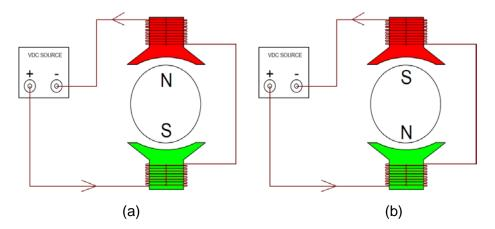
Figura 1.12: (a) Equilibrio inestable y (b) estable del rotor.
