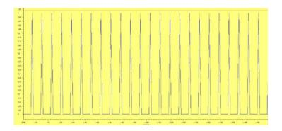
Figura 2.13: Señal del módulo CMTN\_TRIG\_MACRO en su salida.
