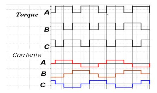
Figura 1.19: Gráfico corrientes modificadas y torques modificados.
