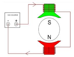
Figura 1.13: Esquema de Motor con polaridad invertida.
