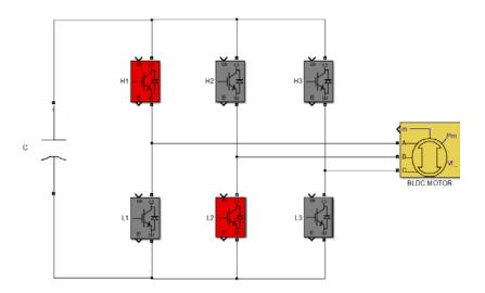
Figura 1.22: Puente Inversor con H1 y L2 encendidos.
