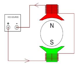
Figura 1.10: Esquema de motor (Equilibrio inestable).
