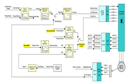
Figura 2.24: Diagrama de bloques correspondiente al nivel de compilación 5 con realimentación de sensores de efecto Hall [7].
