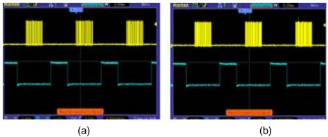
Figura 2.8: Oscilograma de las compuertas 1H y 1L para frecuencia de conmutación fija y (a) ciclo de trabajo del 90% y (b) del 100%.
