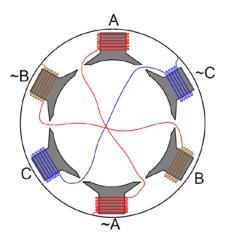
Figura 1.20: Devanados con conexión de punto neutro.
