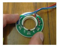
Figura 1.9: Sensores del rotor en el motor.
