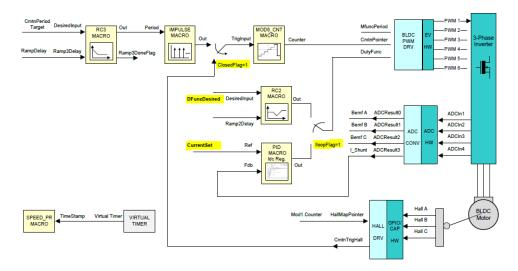
Figura 2.22: Diagrama de bloques correspondiente al nivel de compilación 4, con realimentación de sensores de efecto Hall [7].
