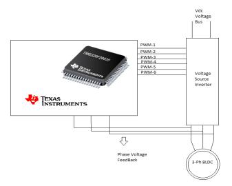
Figura 1.24: Sistema implementado sin realimentación de sensores Hall.
