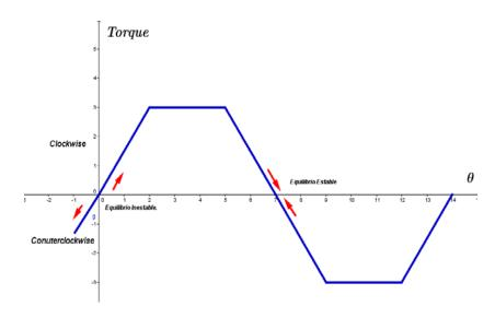
Figura 1.11: Curva de Torque versus ángulo (Ideal).
