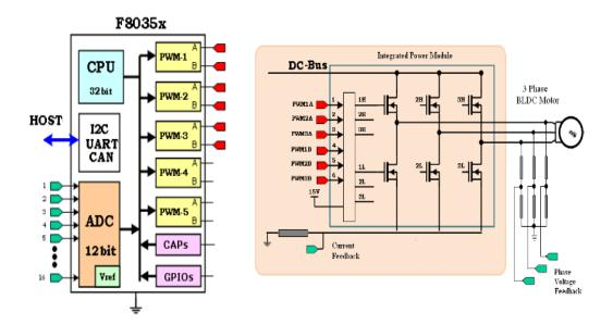
Figura 2.1: Esquema general del sistema [6].
