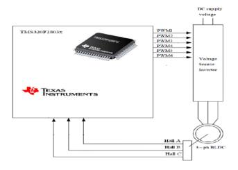
Figura 1.23: Sistema implementado con realimentación con sensores Hall.
