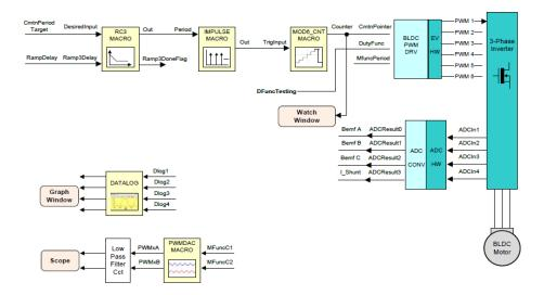
Figura 2.9: Diagrama de bloques del sistema correspondiente al nivel de compilación 2 [6].
