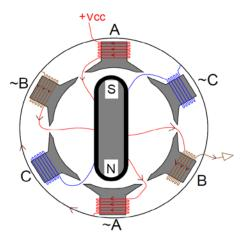
Figura 1.21: Estator con conexión de punto neutro y fase A energizada.
