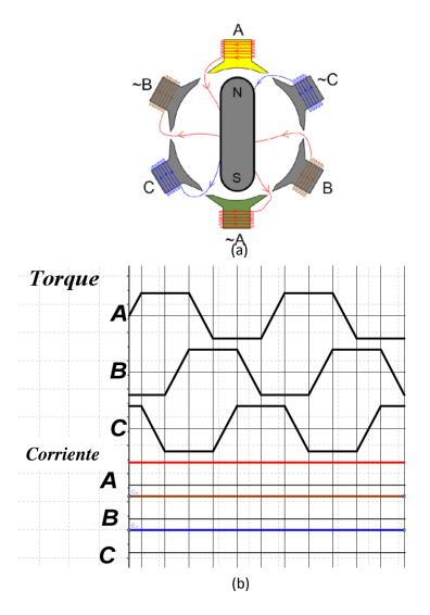
Figura 1.17: (a) Estator con todas las fases energizadas (b) Formas de onda de torque para las tres fases energizadas todo el tiempo.
