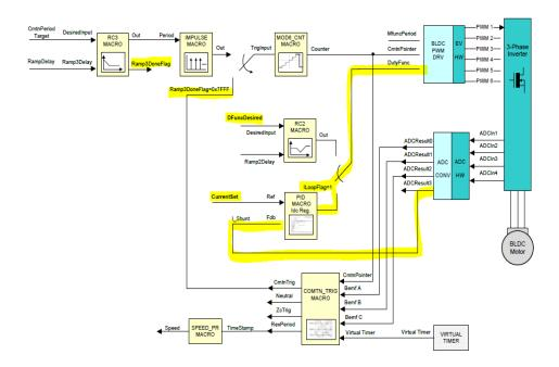
Figura 2.17: Diagrama de bloques correspondiente al nivel de compilación 5 [6].
