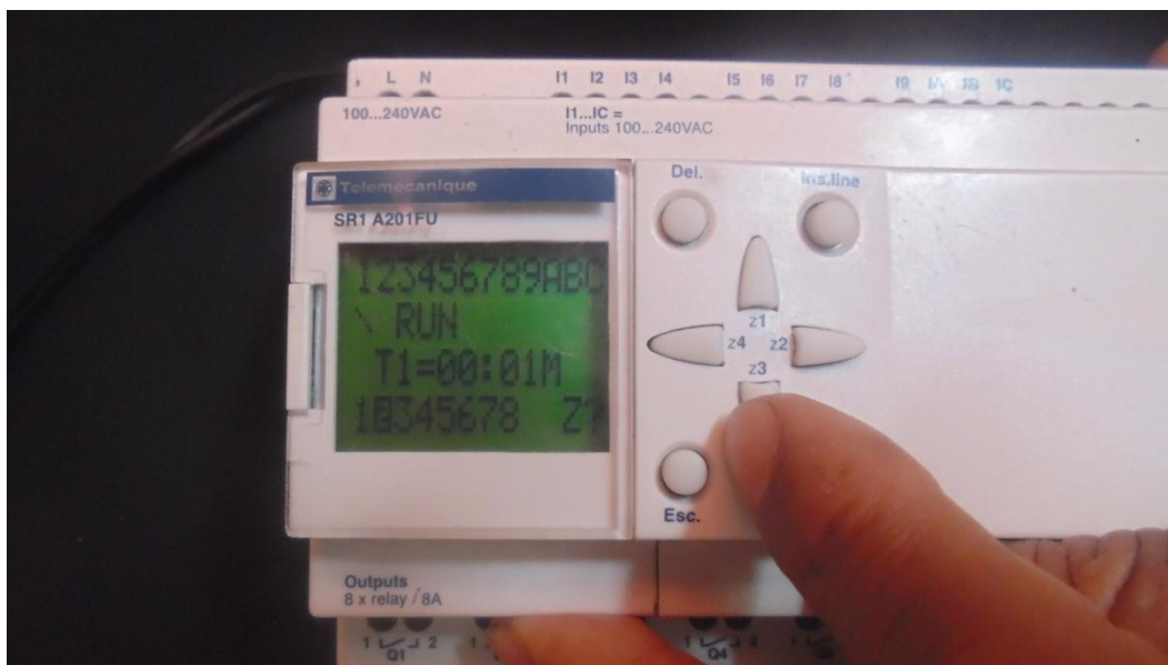
Foto 8: simulando entrada completa de vehiculo, pulsando Z3 acciona mecanismo para bajar puerta, salida Q2.
