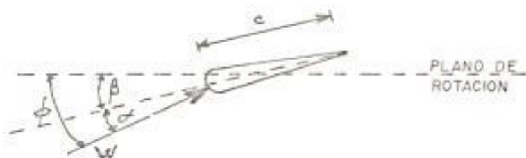
FIG. 3.1 El ángulo de ataque \alpha y el de posición \beta de inclinación de los álabes.
