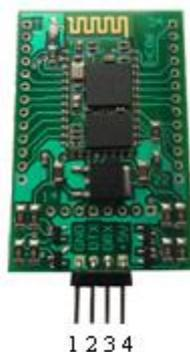
**Figura 2.12 Módulo de comunicación Bluetooth HC06**
