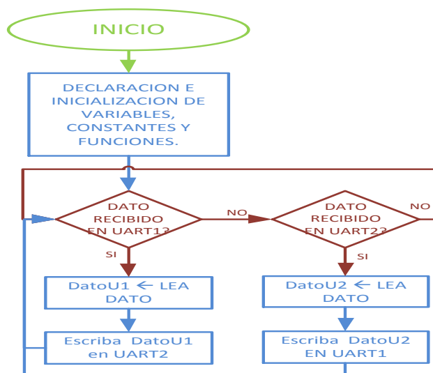
Figura 4.3 Diagrama lógico del funcionamiento de los controladores
