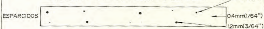
Fig.B2 - NUMERO Y DIMENSION DE POROS PARA SOLDADURAS DE 3mm. (1/8 pulg.) a 6 mm (1/4 pulg) DE ESPESOR
