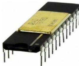
Figura 2.19 Convertidor DAC AD767 DIP [18]
