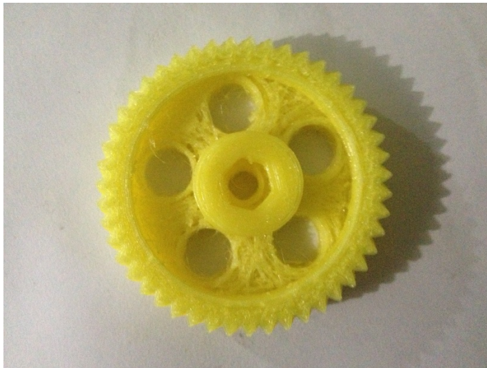
Figura 4.11. Impresión terminada de la rueda dentada.
