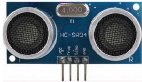
Figura 2.16 Sensor Ultrasónico HCSR04
