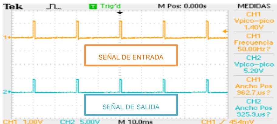
Figura 4.3 Señal PWM de control para Servomotor Codo
