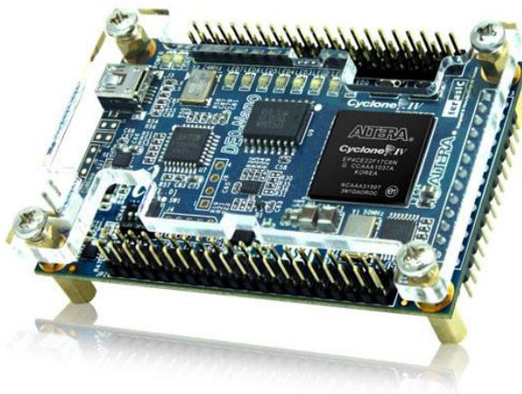
Figura 2.1 Tarjeta DE0-Nano de ALTERA
