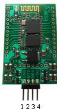
**Figura 2.15 Módulo de Comunicación Bluetooth HC06**
