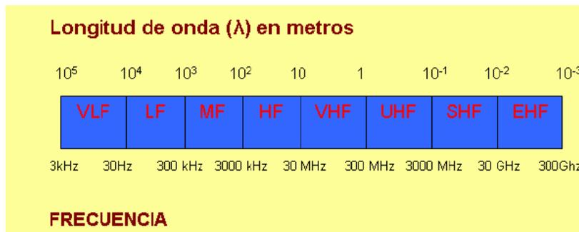
**Figura 2.13 Ubicación del Espectro de Radio Frecuencia**
