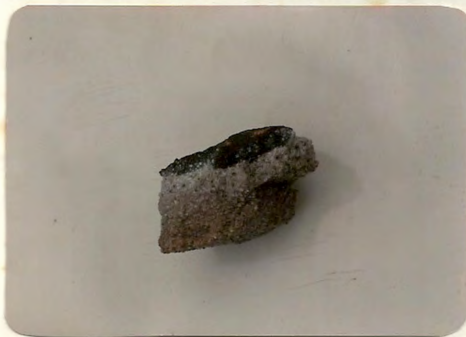
Fig. #18.- MUESTRA DE ZONAS DE SINTERIZACION DEL HORNO DE CRISOL
