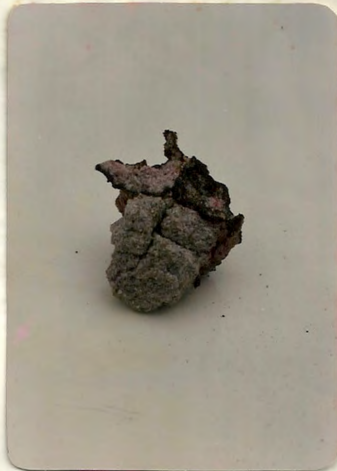
Fig. #17.- PENETRACION DEL METAL EN EL REVESTIMIENTO DEL HORNO DE CRISOL
