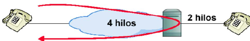
Figura 12. Eco causado por reflexiones en el circuito
