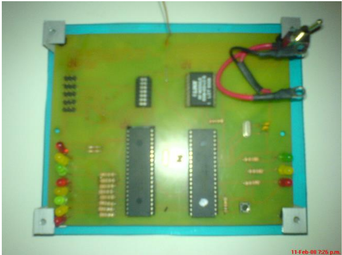
Figura 3.14 – Receptor, controlador (maestro_i2c y esclavo_i2c) y pines para la conexión de los servomotores
