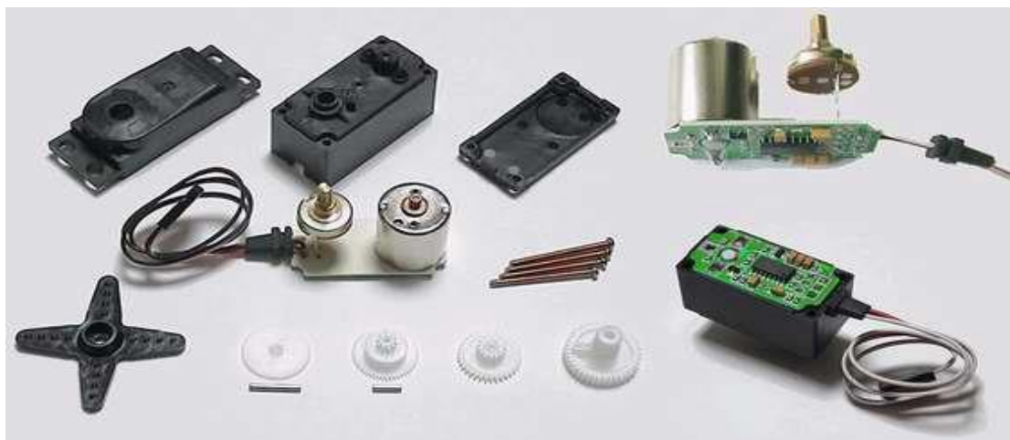
Figura 2.29 - Diferentes componentes de un servo
