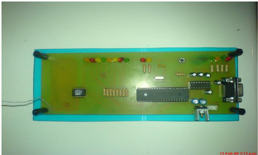
Figura 3.9 – Puerto Serie, fuente 5 voltios (7805), PicModem, MAX-232 y transmisor
