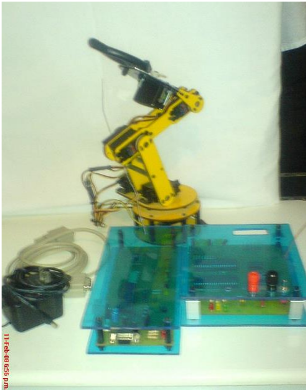
Figura 5.2 – Otra vista de los módulos transmisor, receptor, brazo robot, cable serie y una fuente de alimentación
