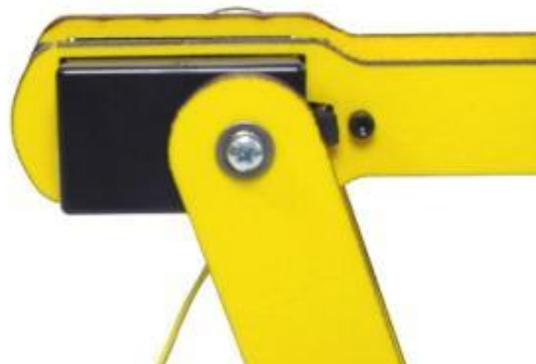
Figura 2.11 - Paso 11 para armar el brazo robótico
