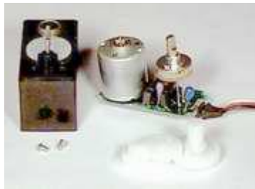
Figura 2.31 - Otro modelo interno de un servomotor
