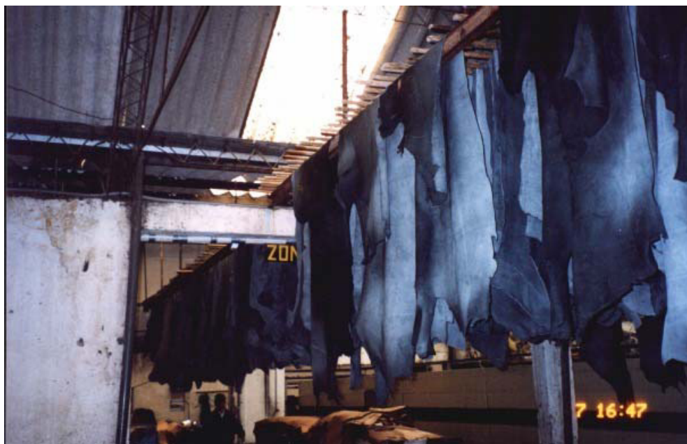
Figura 1.8 Secado al aire de cuero pigmentado con pistola
