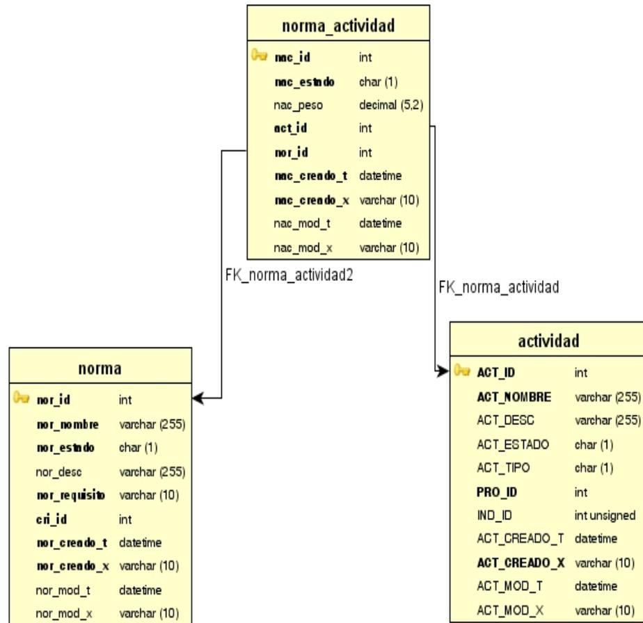
**Figura 3.29 Diagrama físico de Norma-Actividad, fuente Tito Peralta,**
