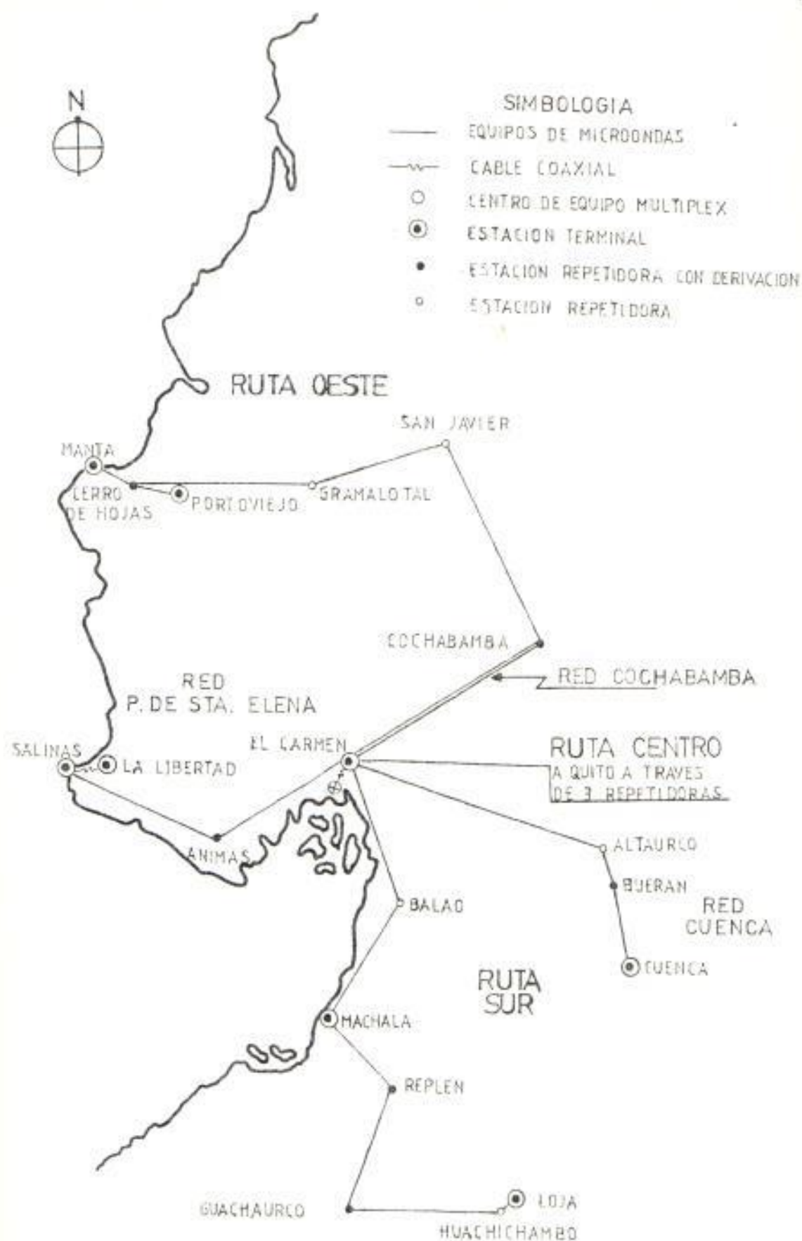
Figura N° 2.2.- Sistema actual de microondas del IETEL R-2
