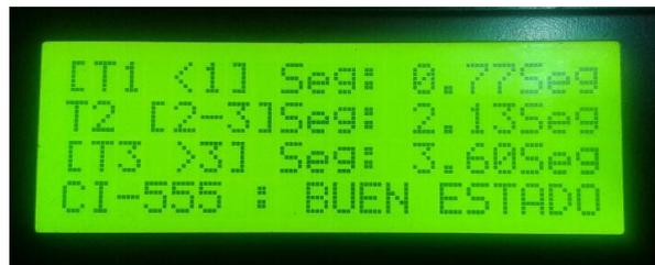
**Figura 4-3 Verificación del estado del IC555**
