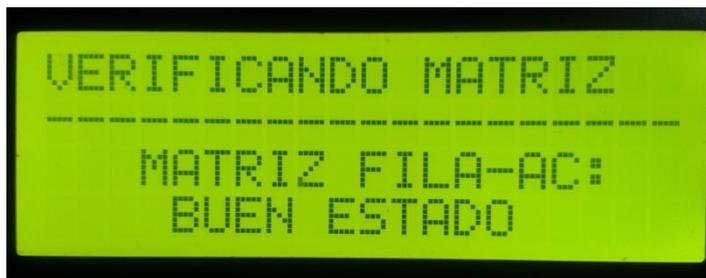
**Figura 4-7 Prueba del Display matricial 7x5**
