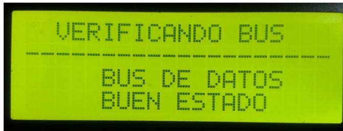
**Figura 4-8 Prueba de Bus de Datos**
