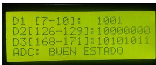
**Figura 4-4 Prueba del convertidor ADC**
