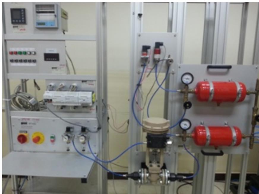
**Figura 3.31:** Planta de Regulación de Presión
