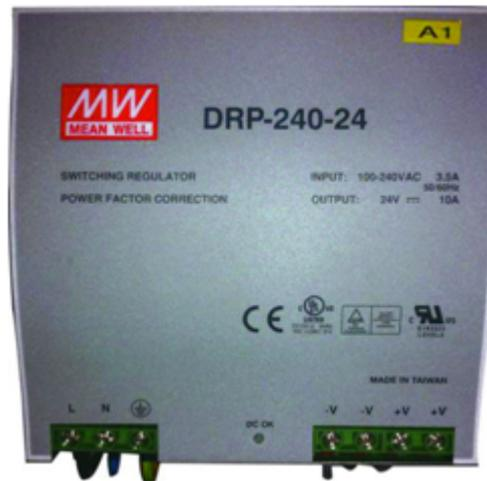
**Figura 2.14:** Fuente de voltaje de 24 Vdc.
