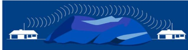
Figura 2. 11 Propagación por onda de superficie [22].
