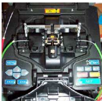
Fig. 1-16.- Fibra óptica colocada en la Fusionadora
