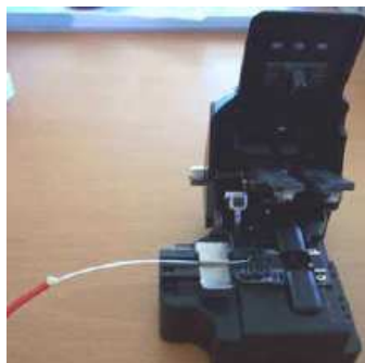
Fig. 1-15.- Fibra óptica colocada en la peladora
