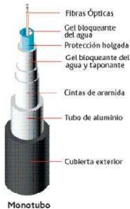
Fig. 4.10.- Morfología del cable de fibra utilizada
