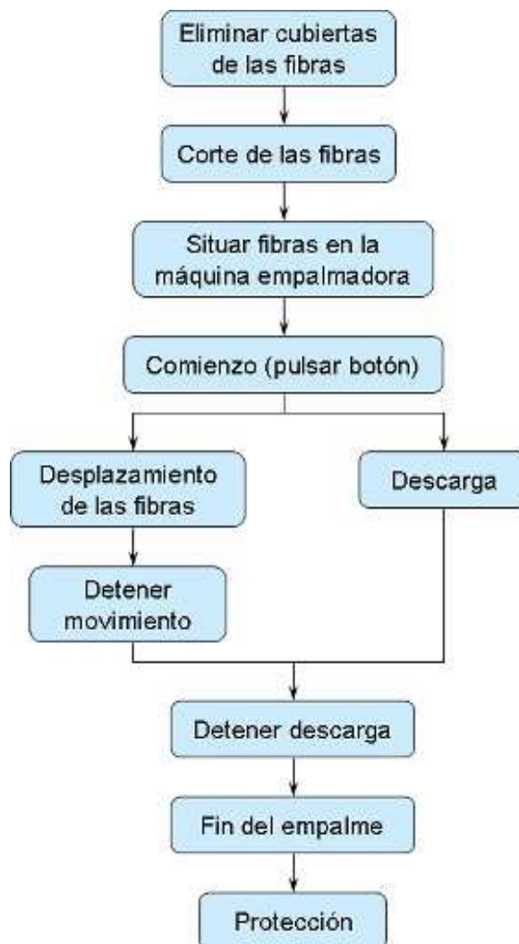
Fig. 1-12.- Procedimiento de empalme de fibras por fusión.
