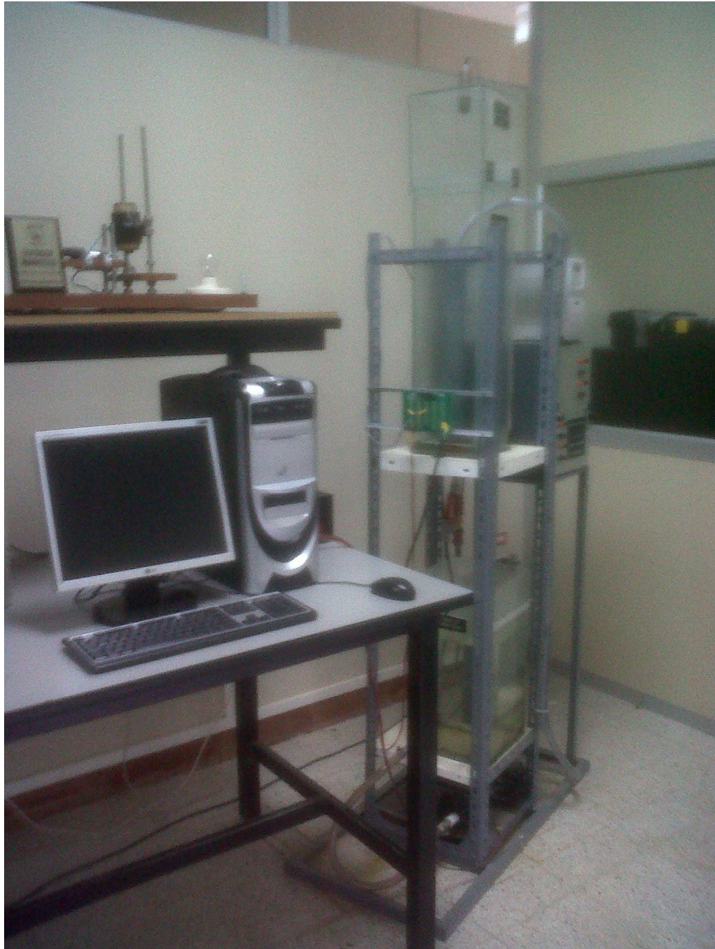
Figura 4.11 PLanta de Tanque de Agua
