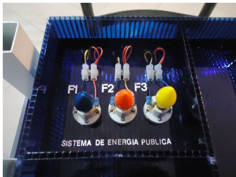
Figura 3.1 Carga conectada a Energía publica "Trifásica"
