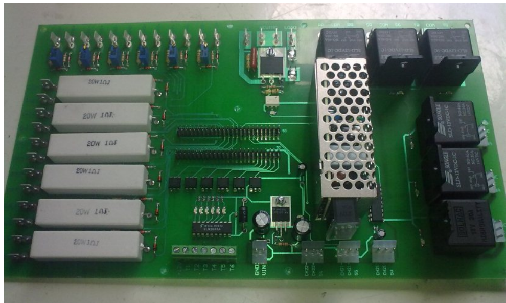
Figura 3.5. Tarjeta de acondicionamiento de señales
