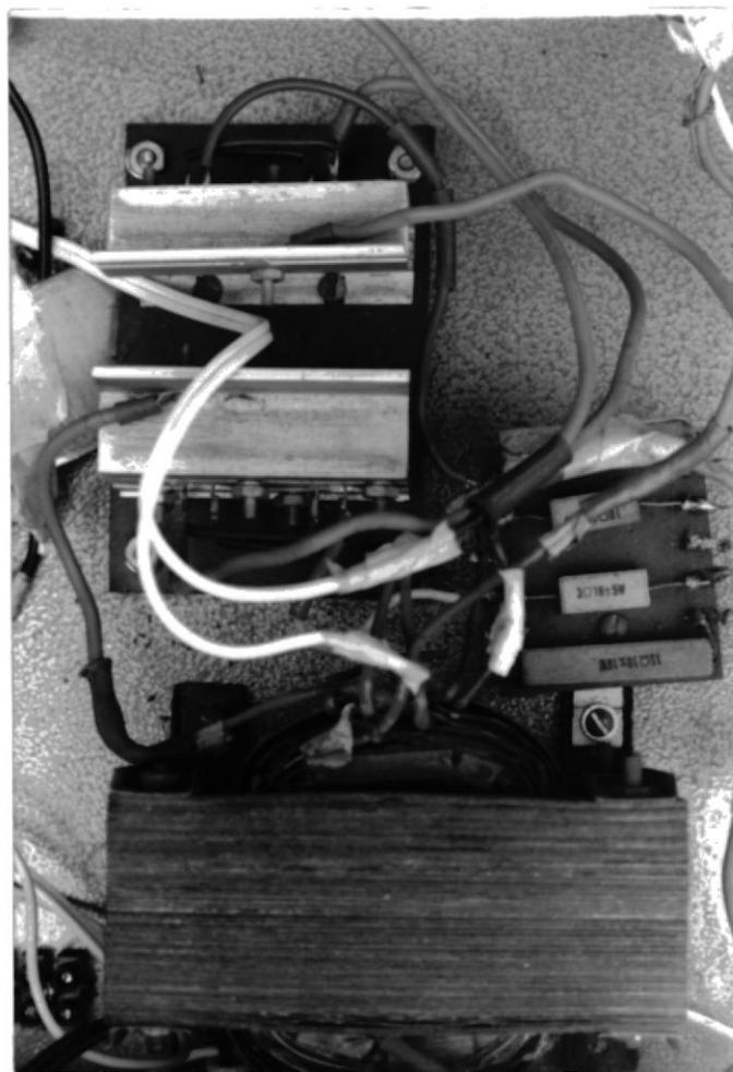
FIGURA 2.4.- VISTA SUPERIOR DEL INVERSOR DE LA FUENTE DE EMERGENCIA
