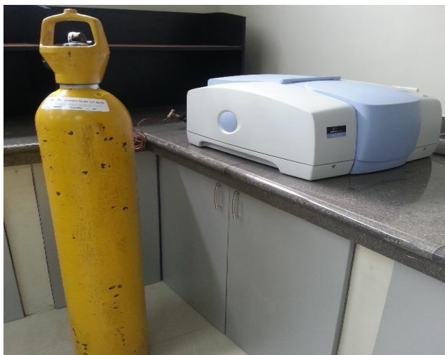
Figura 3.18. Espectrómetro infrarrojo de marca Perkin Elmer modelo Spectrum 100.
