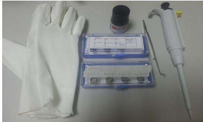
Figura 3.21. Materiales empleados en la preparación de la muestra para el análisis del SEM.
