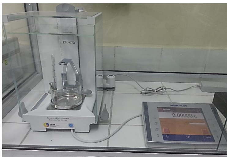
Figura 3.16. Balanza para determinación de densidad Mettler Toledo XP205.
