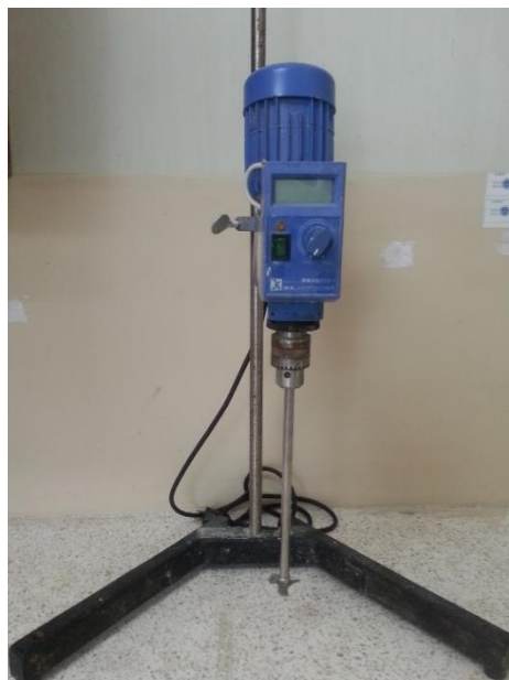
Figura 3.12. Agitador mecánico Ika Labortechnik modelo RW20DZM
