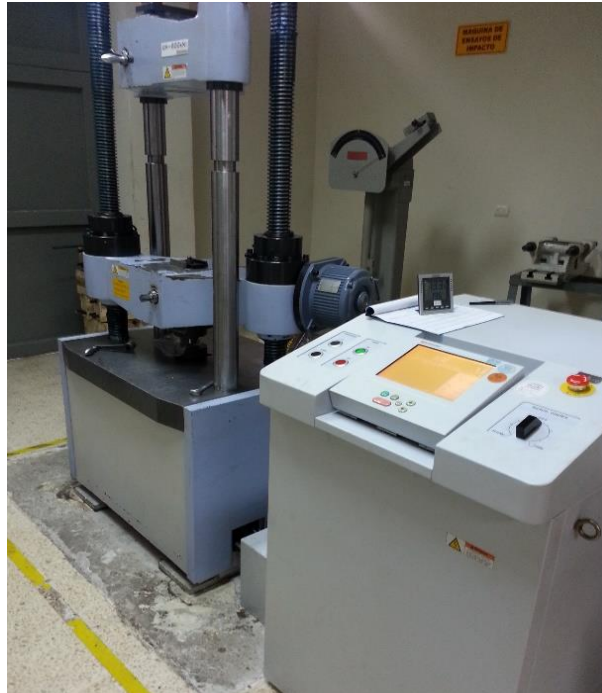
Figura 3.11. Máquina de Ensayos Universales SHIMADZU UTM-600KN
