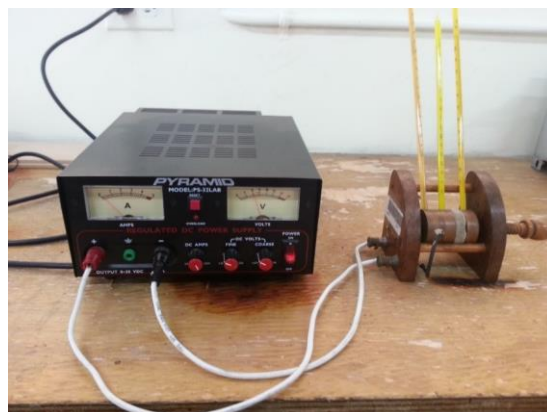
Figura 3.15. Equipo para determinación de la conductividad térmica en materiales aislantes.
