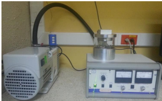
Figura 3.22. Equipo de recubrimiento de platino marca EMITECH.
