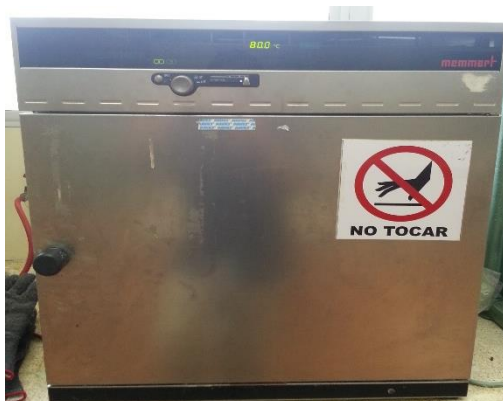
Figura 3.1. Estufa MEMMERT: Secado de Zeolita Natural.
