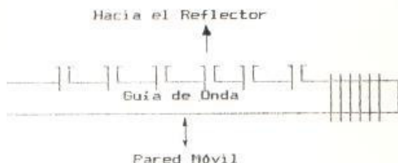
fig. 3.12 Alimentación de una antena cilíndrica con Guía de Onda Compresible.
