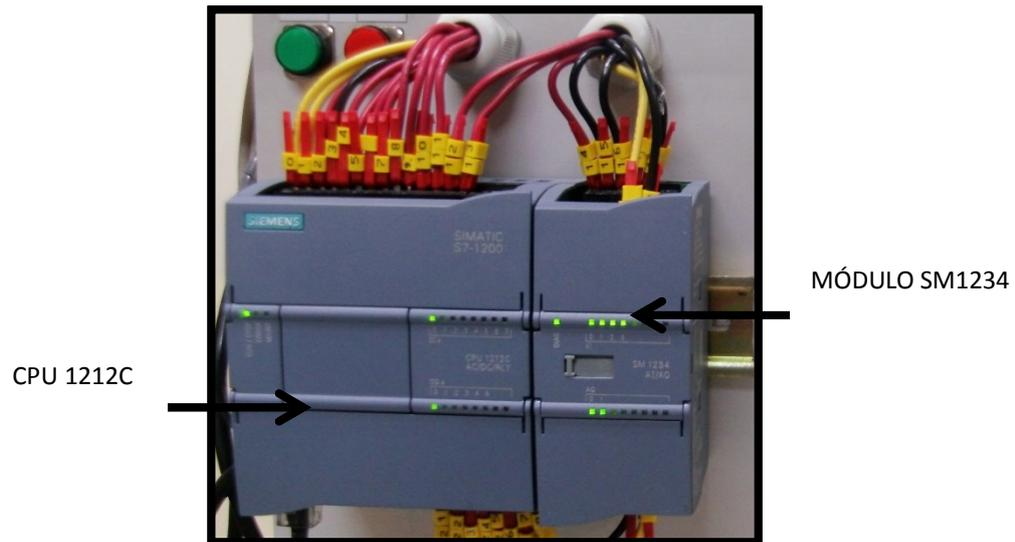
Figura 2.8 CPU 1212 AC/DC/relé y SM1234 ensamblados
