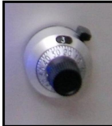
Figura 3.2 Potenciómetro de precisión 10 K $\Omega$  10 vueltas
