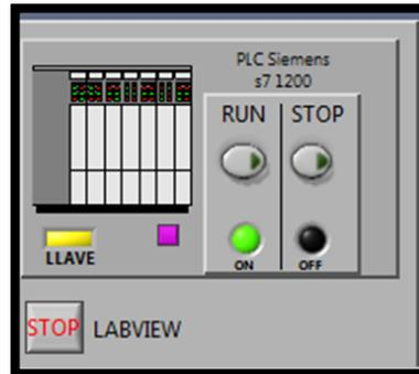
Figura 3.18 Controles para Arranque y Paro desde aplicación en Labview
