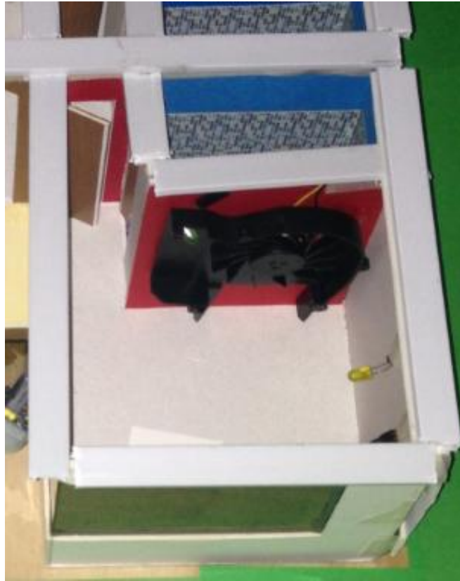
Figura 4.3 Ubicación de sensor de temperatura y ventilador
