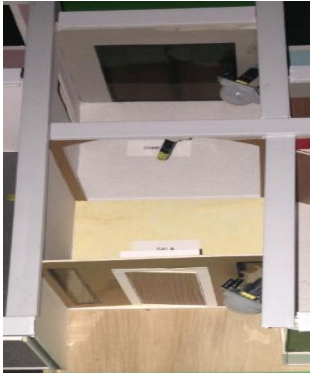
Figura 4.7 Ubicación de sensores de presencia
