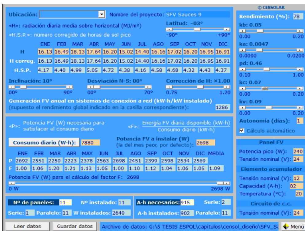
Figura 3.13 Dimensionamiento del SFV obtenido con Censol 5
