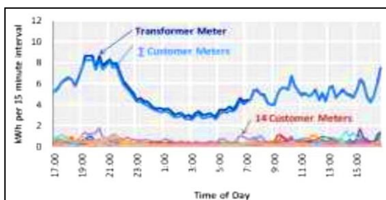
Figura 1.14 Curva del Balance de Energía para un Transformador de Distribución Tomada de un Medidor AMI [17]
