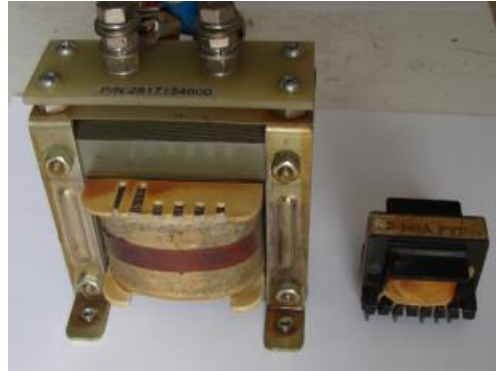
Figura 2.5. Transformadores de baja (Izq.) y alta frecuencia (Der.).
