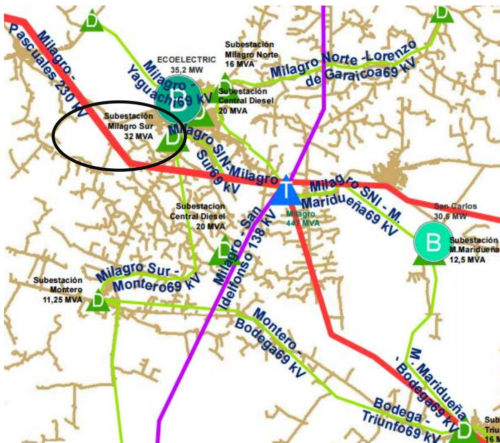
Figura 1.1 Alimentación de la subestación Milagro Sur [1].
