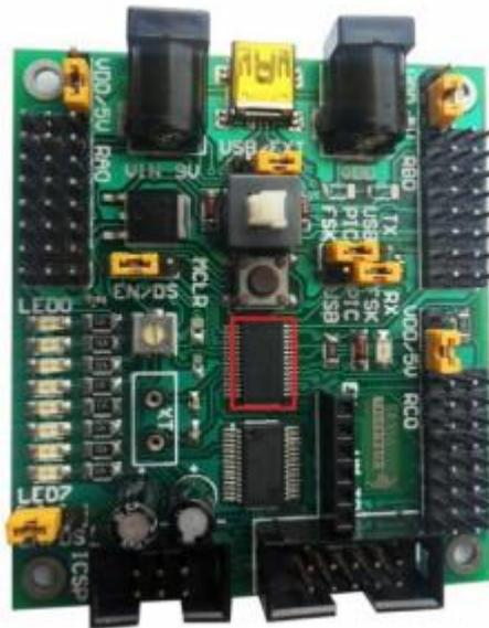
FIGURA 3.2 Módulo PIC 16F886 (Obtenido de Manual M.E.I&T)
