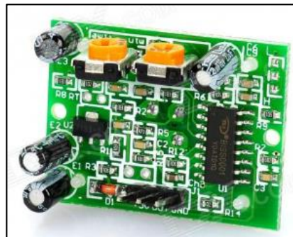
Figura 2.5 - Potenciómetros del sensor de presencia PIR HC-SR501 [5]
