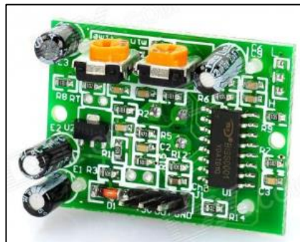
Figura 2.5 - Potenciómetros del sensor de presencia PIR HC-SR501 [5]
