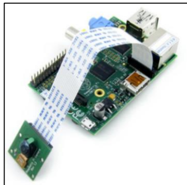
Figura 2.8 - Conexión RaspiCam con el Raspberry pi [8]
