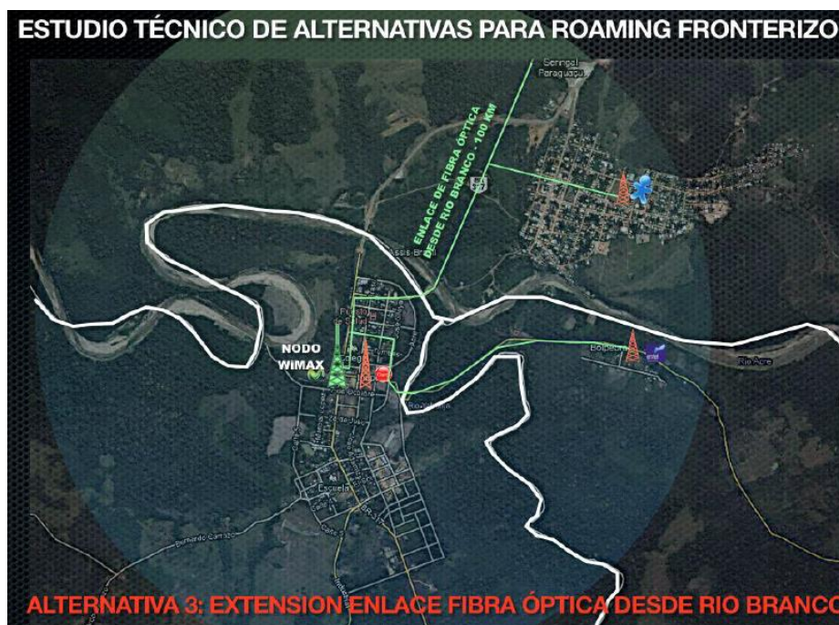
Figura 1.9 Instalación de Enlace de Fibra Óptica desde Rio Branco [3]
