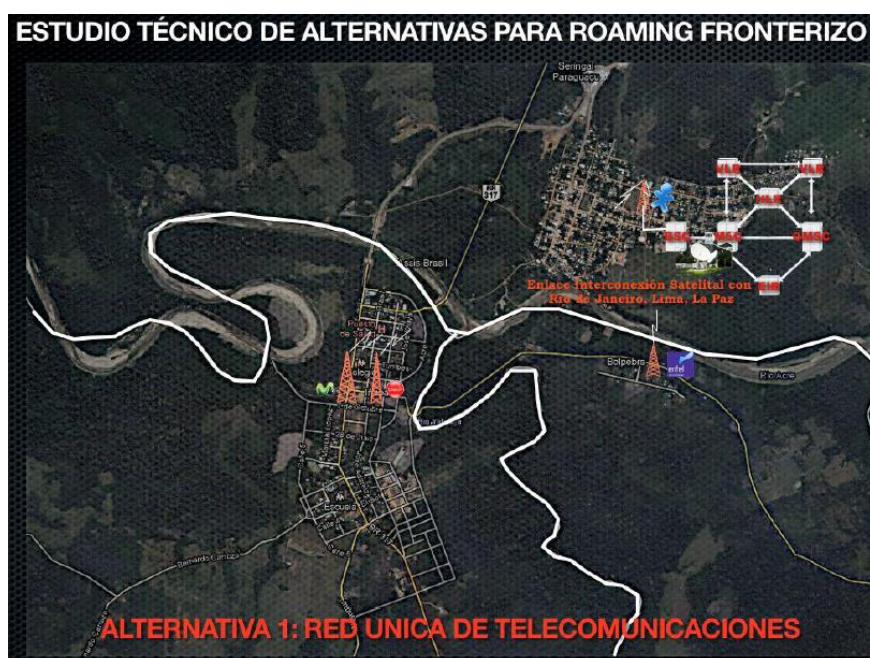
Figura 1.7 Alternativa de Red Única para Roaming Fronterizo [3]
