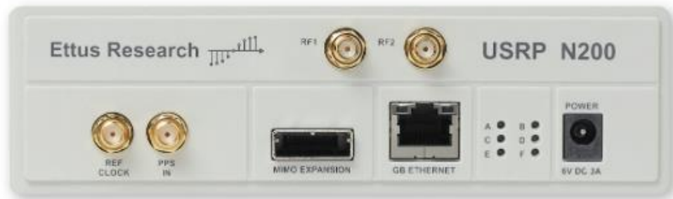
Figura 23. Vista Posterior del USRP.
