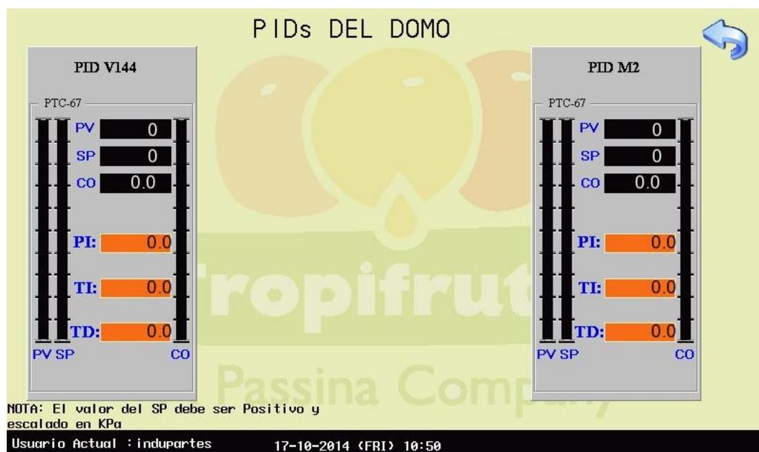
Figura 2.10: Pantalla PIDs del Domo Separador de Aire
