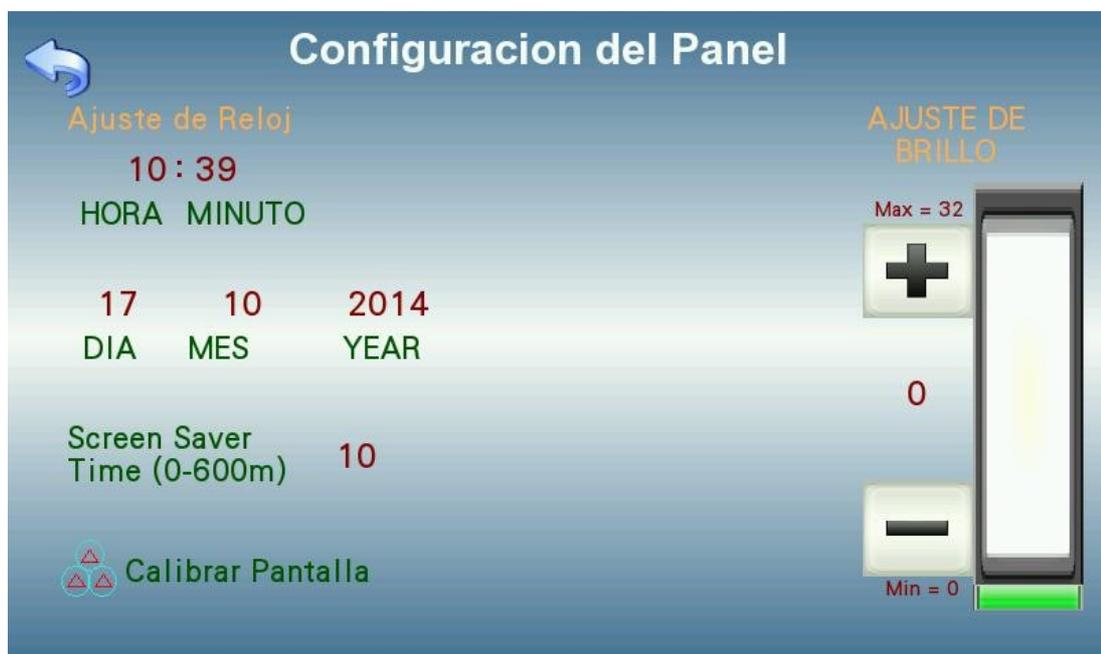
Figura 2.12: Pantalla Configuración del HMI
