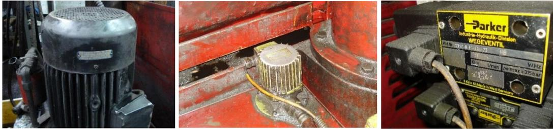
Figura 1.3: Motor principal, motor de bomba de pulido y electroválvulas.
