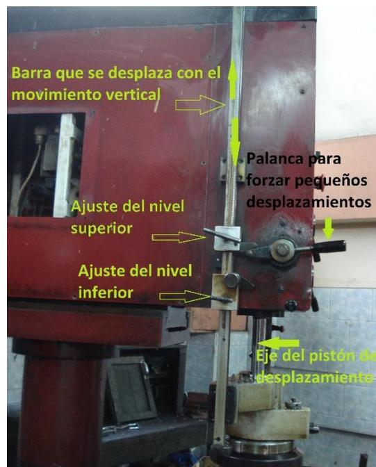
Figura 1.2: Control del desplazamiento
